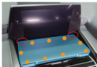
③ 操作パネルを固定しているボルト4本を外す。
