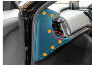
⑦ グローブボックス下、アンダーカバーASSYのパネルのサイドを持ち、下方向に下げて取外す。パネル裏のカプラーを1か所外す
