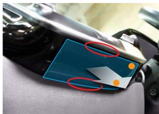
②下図の赤丸部分に内張剥がしを挿し込み、ツメおよびクリップのかん合を外し、上手前方向へ取外す。(ツメ・クリップのかん合9か所)
