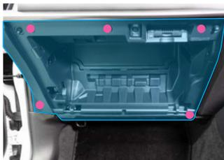
※「HDMI延長ケーブル」と「USB延長ケーブル」をグローブボックス内に通すためには、グローブボックス奥のパネルカバーに加工が必要です。
